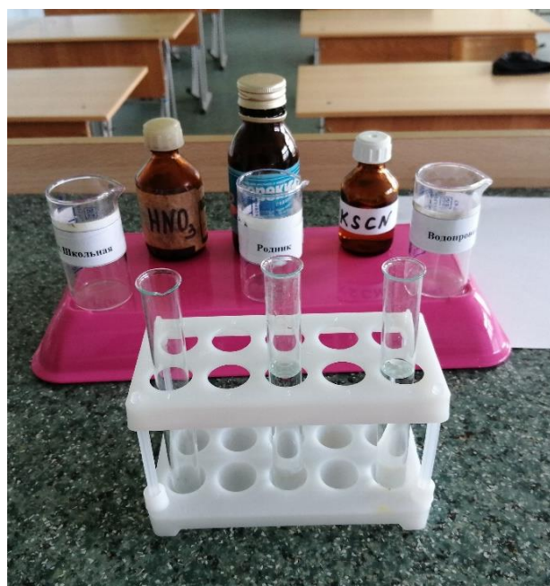
Фото 22. Химические реактивы для обнаружения железа
