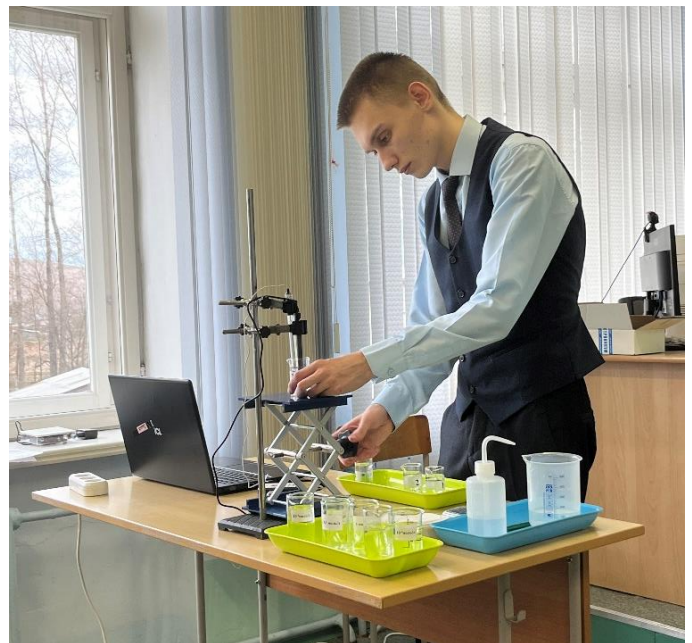
Фото 35. Определение нитрат-ионов в образцах воды
